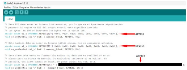
Fig. 6. Porción de código del dispositivo donde se asignan los valores de autenticación del gateway .
