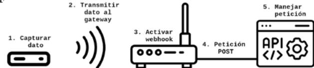
Fig. 9. Esquema del proceso de captura y almacenamiento de datos.
